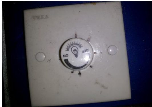
Gambar 3.15. Pengatur Intesitas UV menggunakan Dimmer Lamp
