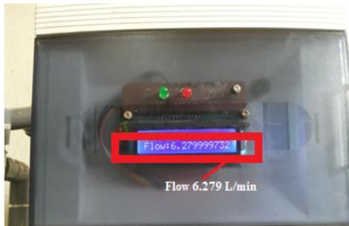
Gambar 4.28. Pengujian sampel air dengan kecepatan aliran air sebesar 6.279 L/min
