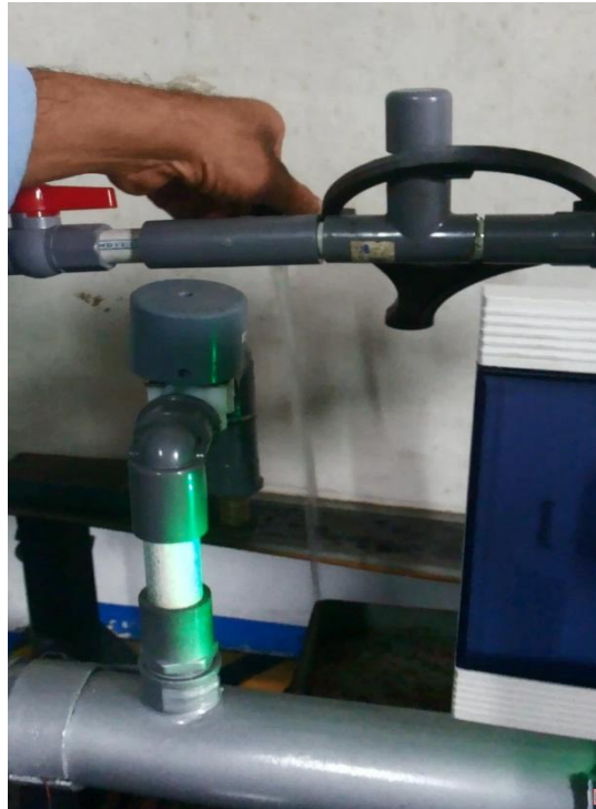
Gambar 4.23. Proses sterilisasi air dengan cara flushing atau pengurasan
