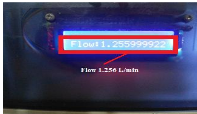
Gambar 4.30. Pengujian sampel air dengan kecepatan aliran air sebesar 1.255 L/min
