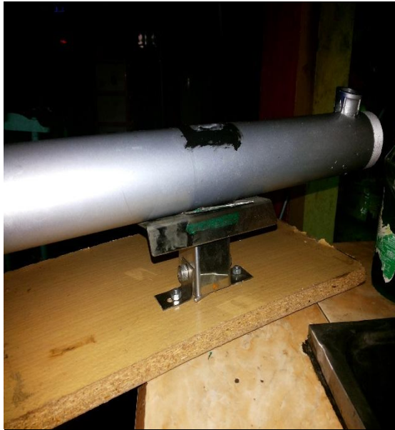
Gambar 4.4. Pembuatan dan pemasangan tabung reaktor ultraviolet.
