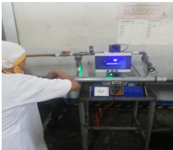
Gambar 4.27. Proses sterilisasi air dengan cara flushing atau pengurasan
