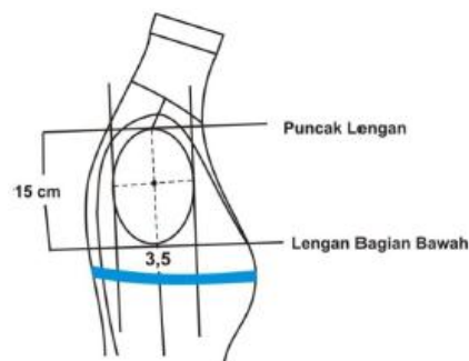
Gambar 2.10 Pemasangan body line pada lengan (Sumber: Modul Teknik Draping )
