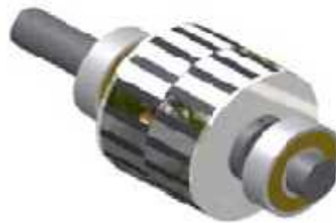
Gambar 2.18. Beberapa kemungkinan posisi magnet permanen pada rotor, (a) lurus, (b) digeser dari posisi a, (c) digeser dari posisi b, (d) digeser dari posisi c.
