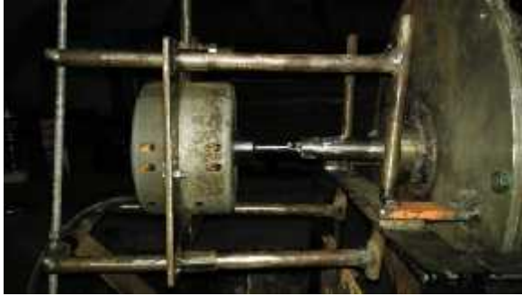
Gambar 4.7. Generator Dan Turbin Saat Terhubung
