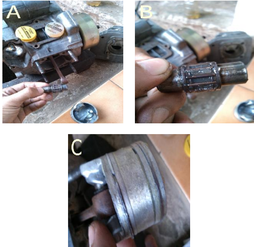
Gambar 3.15 (A) Pen Piston Sebelum Diberi Gemuk, (B) Pen Piston Setelah Diberi Gemuk dan (C) Pemasangan Piston Dengan Gemuk.
