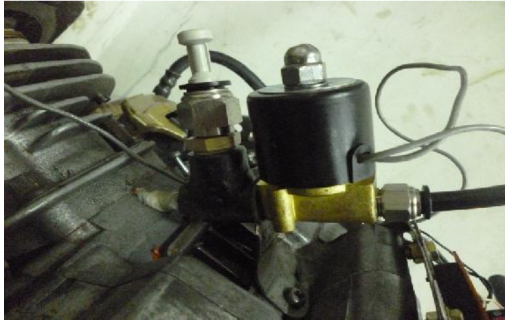
Gambar 3.17 Pemasangan Rangkaian Solenoid Valve Pada Lubang Crank Case .
