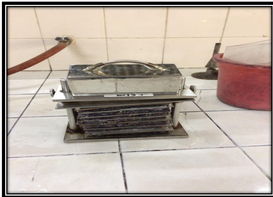
Proses Uji Ketahanan Luntur Warna Terhadap Air
