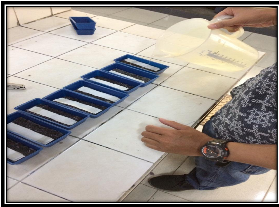
Proses Uji Ketahanan Luntur Warna Terhadap Air
