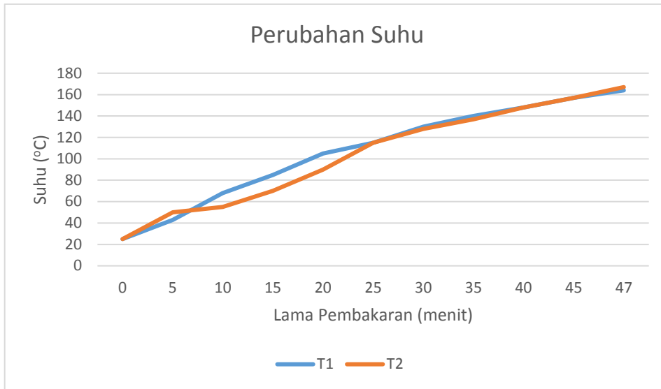
Gambar 4.6. Grafik Perubahan Temperatur pada Volume Air 19 L
