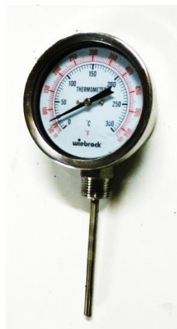
Gambar 2.11. Bimetal Termometer Model Raket (sumber : Dokumentasi Pribadi)
