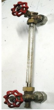
Gambar 2.9. Sight Glass (sumber : Dokumentasi Pribadi)
