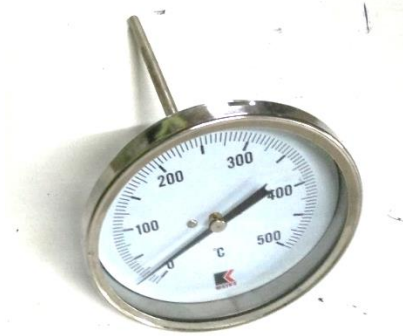
Gambar 2.10. Bimetal Termometer Model Payung (sumber : Dokumentasi Pribadi)
