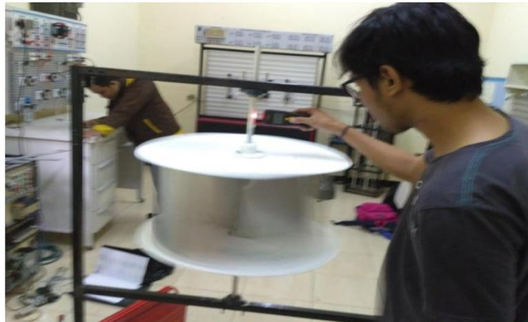
**Gambar 3.8** Pengujian turbin angin dengan *blower*
