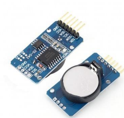
Gambar 2.6. Modul RTC DS1307
