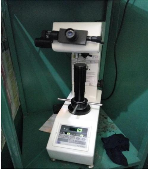
Alat Pengujian Kekerasan
