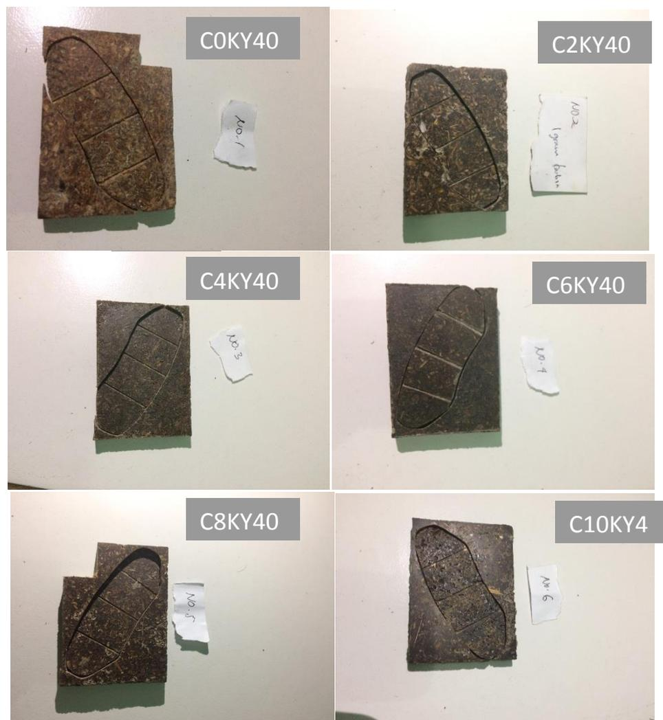
**Gambar 4.11 Spesimen Uji Kekerasan Komposit Serbuk kayu dan Serbuk Karbon**
