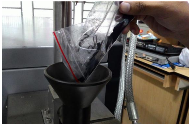
Gambar 3.15. Proses Memasukkan CNT ( Carbon Nanotube )
