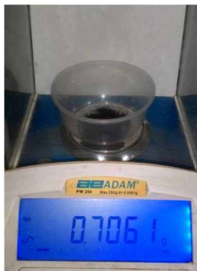
Gambar 3.11. Penimbangan CNT ( Carbon Nanotube )
