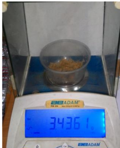
Gambar 3.10. Penimbangan Serat Batang Pisang yang Telah Dilakukan Proses Alkali
