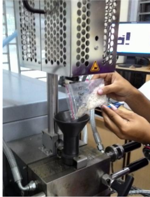
Gambar 3.14. Proses Memasukkan HDPE
