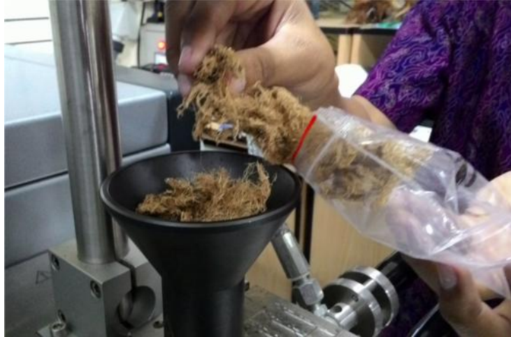
Gambar 3.16. Proses Memasukkan Serat Batang Pisang
