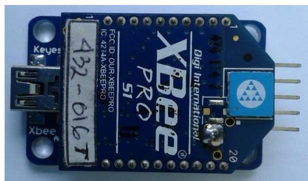
**Gambar 2.24. XBee dengan Papan Konektor**
