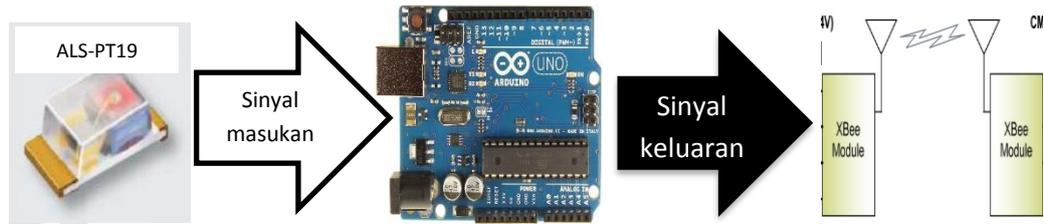
**Gambar 2.16. Sistem Kerja Arduino Uno**
