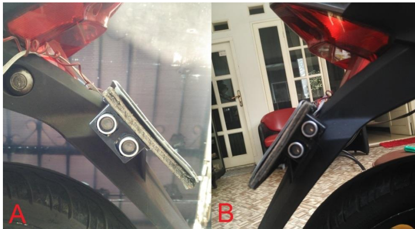
Gambar 4. 2 Penempatan Sensor Jarak Ultrasonik
