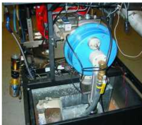
Gambar 2.11. Dinamometer Mengukur Torsi Mesin Dengan Menerapkan Hambatan Gaya Ke Mesin Dan Mengukur Gaya Terapan.
