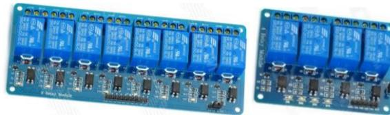
Gambar 2.10. Relay Module 8 Channel (kiri) dan Relay Module 4 Channel (kanan)
