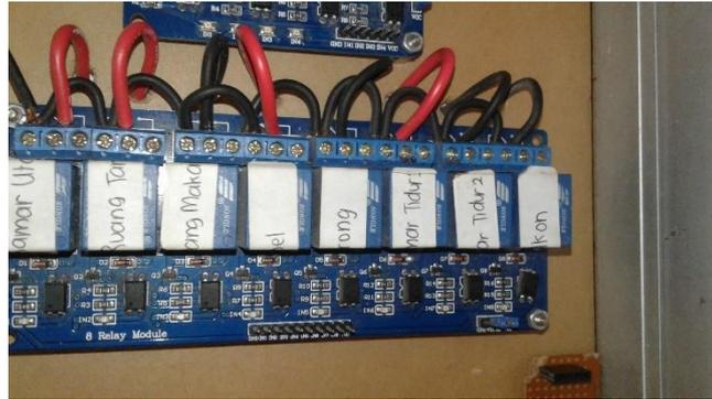
Gambar 4.5. Pemasangan Relay 8 channel untuk lampu
