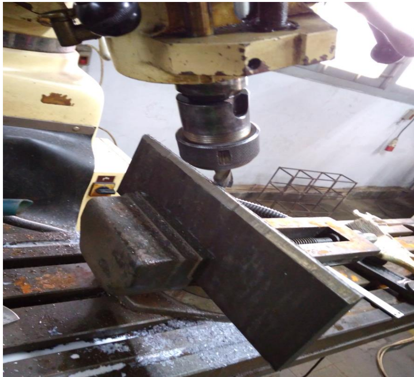
Gambar 3.2 Pembuatan kampuh X
