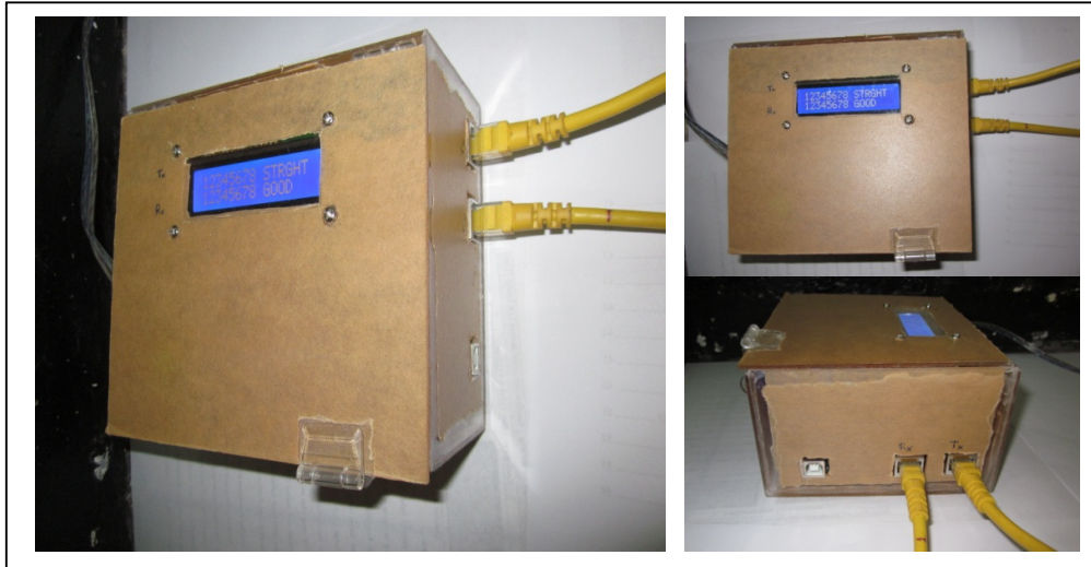
Gambar alat penguji kabel LAN Berbasis Mikrokontroler
