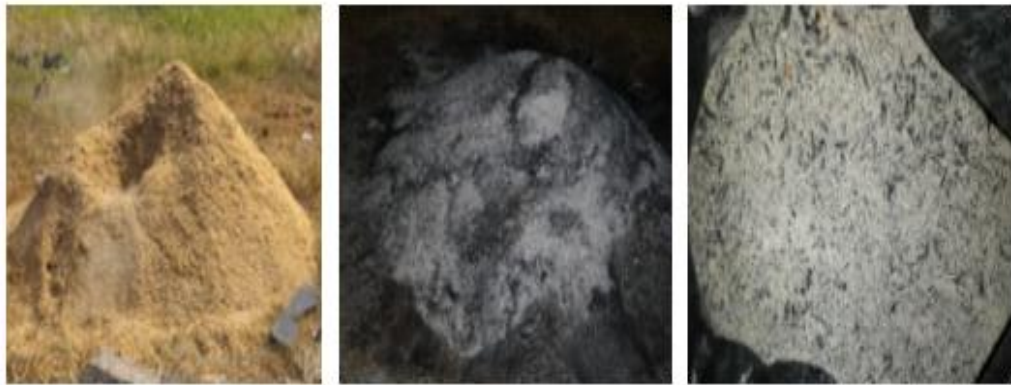
Gambar 3.2. Proses Pembakaran Sekam Padi (a) Sekam padi; (b) Sekam padi di bakar; dan (c) abu sekam padi
