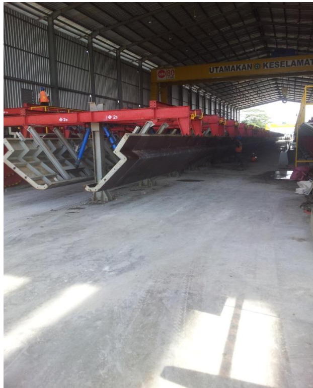
Gambar 2.3 Pembersihan dan Pemberian Minyak Pada Moulding
