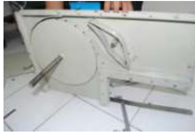
Gambar 4.2. Bagian Dalam Turbin Cross Flow
