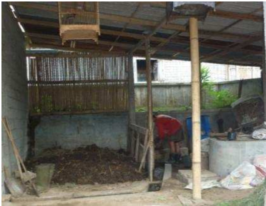
Foto 5. Proses pemasukan kotoran ke dalam biodigester melalui inlet. Sebelum dimasukkan, kotoran dilakukan pengenceran terlebih dahulu. Pada gambar ini adalah proses pengenceran secara manual
