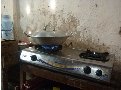
Foto 1. Pemanfaatan biogas untuk memasak pada kompor gas biasa. Api biru yang dihasilkan menandakan biogas memiliki kandungan gas metana yang baik
