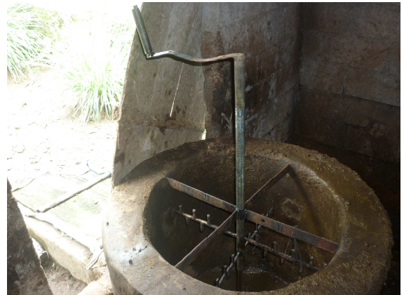
Foto 6. Alat pengaduk mekanik sederhana yang membantu proses pengenceran kotoran. Sehingga meringankan proses pemasukan bahan isian ke dalam biodigester.
