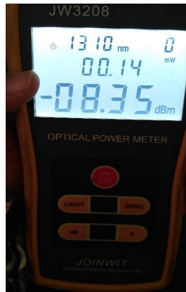
Gambar 4.1 Tampilan Layar OPM Saat Pengukuran
