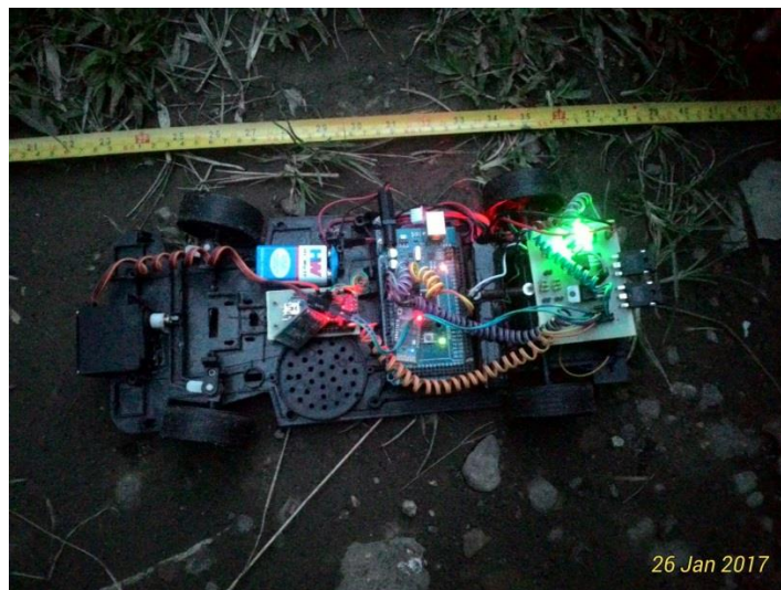
Gambar 4.11. Pengukuran Jarak Tempuh Mobil RC Menggunakan Meteran
