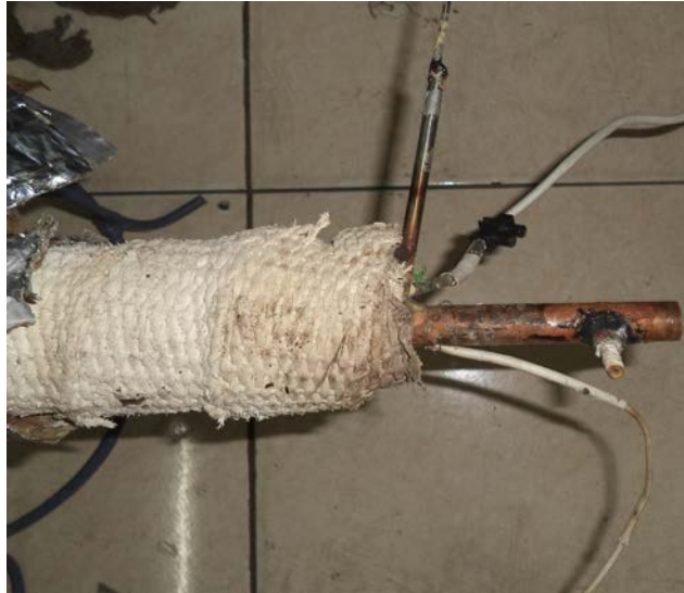
Gambar 3.3 Seksi Uji Dilapisi Dengan Sabuk Asbes
