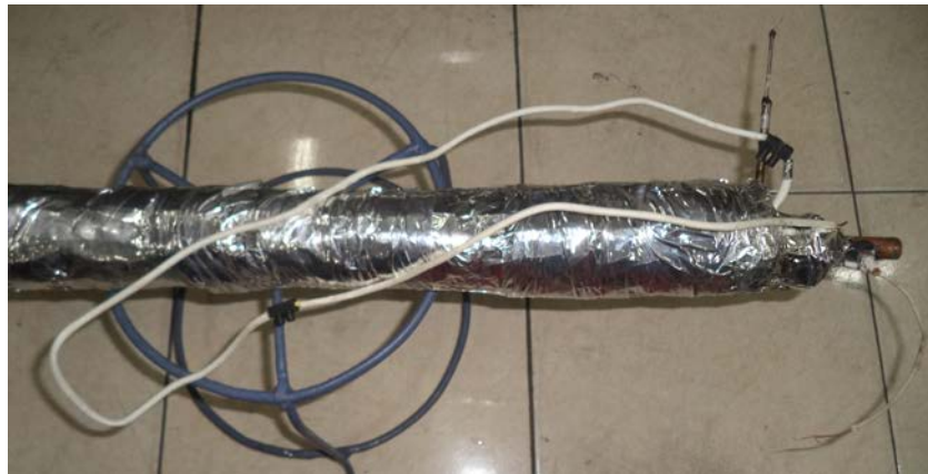
Gambar 3.4 Seksi Uji dilapisi dengan alumunium foil dan nikelin disambung dengan kabel listrik
