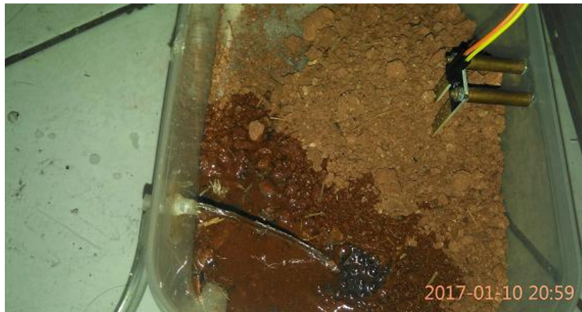
Gambar 4.7 Proses Pemberian Air Saat Tanah Kering
