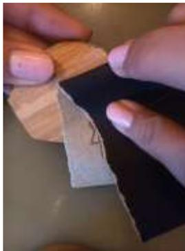
**Gambar 4.11 Proses pengamplasan permukaan bambu**
