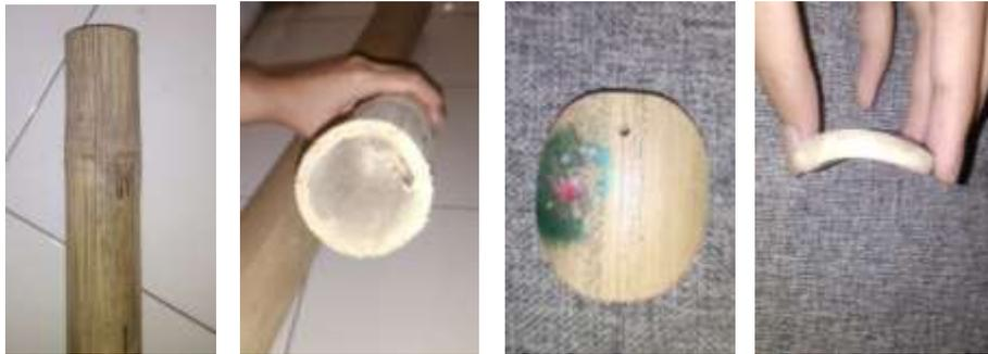
**Gambar 4.2(a) (b) (c) (d) Hasil pemotongan bambu pada diameter bambu yang lebih kecil**
