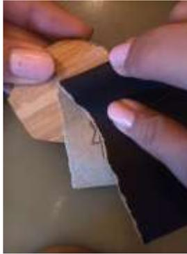
**Gambar 3.8** Proses pengamplasan permukaan bambu
