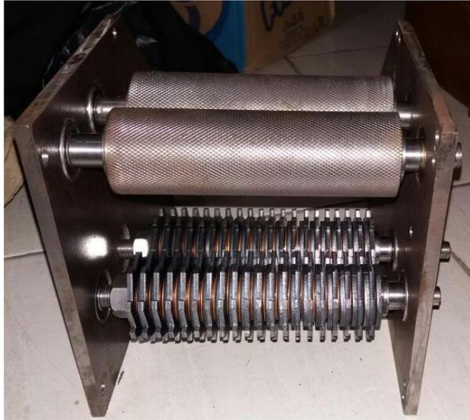
Gambar 4.41 *Assembly* poros pisau dan *roller* pemipih pada dudukan
