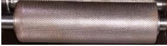
Gambar 4.40 Hasil pembuatan *roller* pemipih
