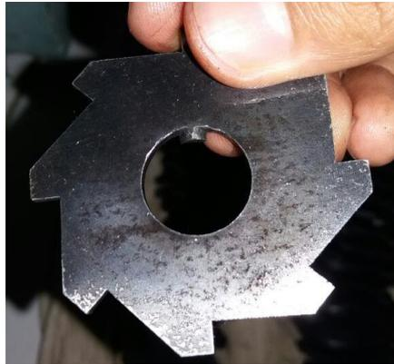
Gambar 4.37 Hasil pisau pencacah setelah proses *quenching*
