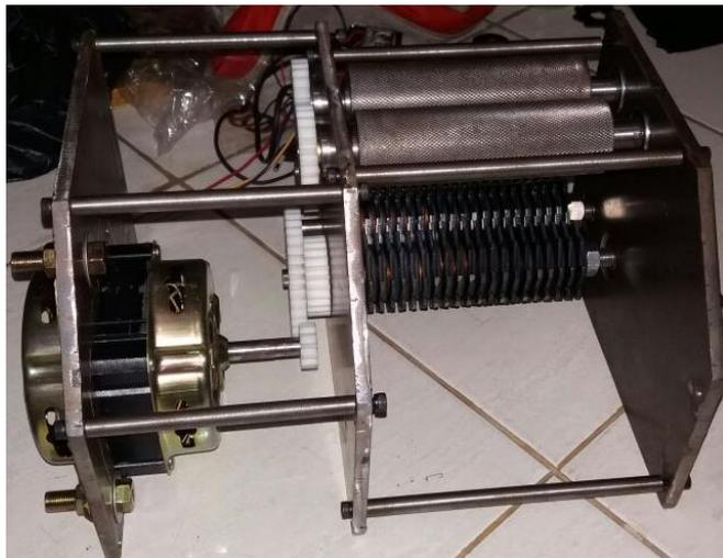
Gambar 4. 42 Penempatan motor penggerak dan roda gigi pada mesin
