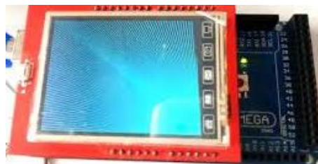
Gambar 3. 4. Pengintegrasian Arduino dengan LCD Touchscreen
