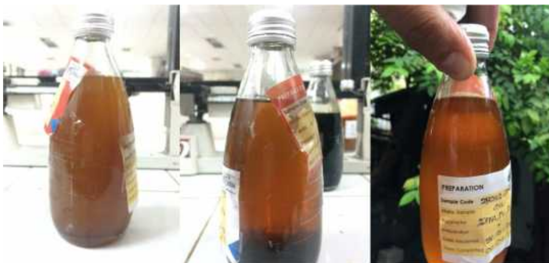
Gambar 4.2. Minyak Nyamplung yang sudah di- degumming dengan asam fosfat 1%, 2%, dan 3% dari volume minyak biji nyamplung (kiri ke kanan)
