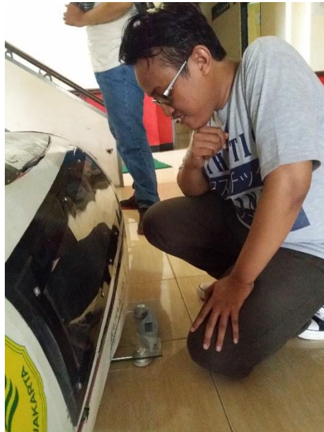
Gambar 3.3. Menimbang Berat Roda Kanan Kendaraan
