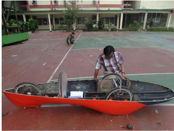
Gambar 4.22 Pengujian Selisih Sudut Belok terhadap Pusat Belok
