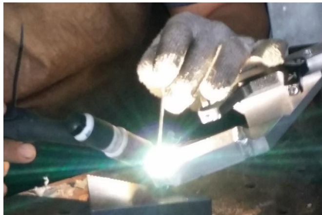
Gambar 4.13 Pengelasan Lengan Pitman ke Knuckle Roda
