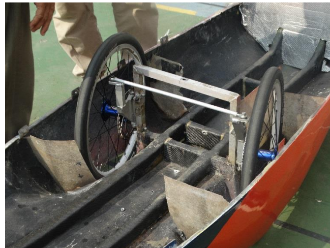
Gambar 4.14 Proses Assembly Komponen Spindle Arm , Spindle Cradle , Knuckle dan Roda.
