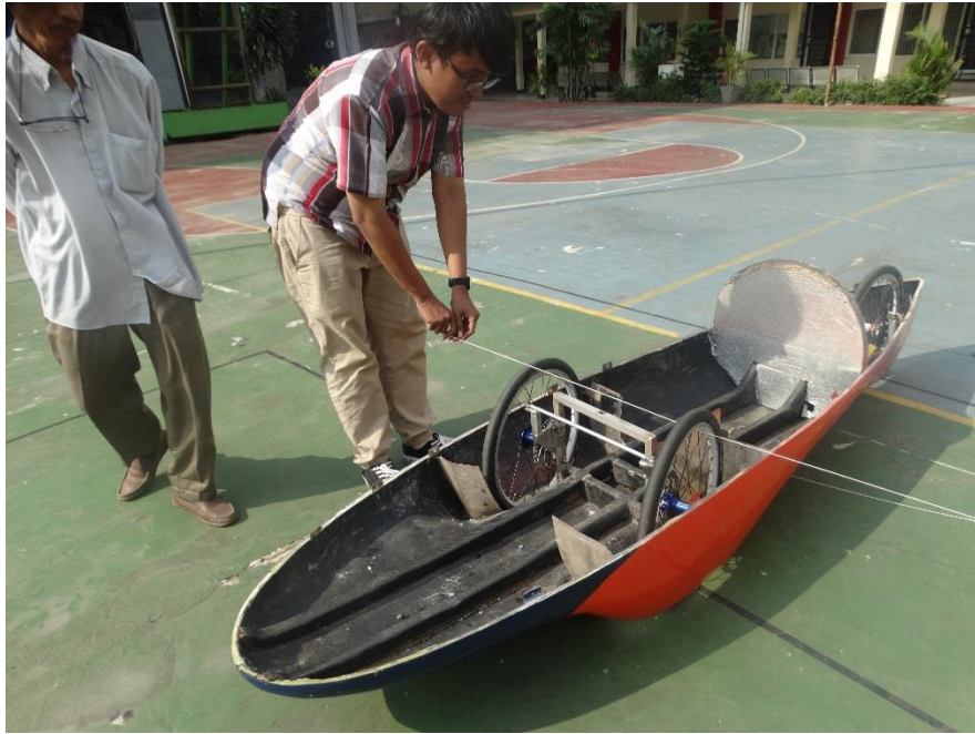
Gambar 4.20 Pengujian Outer Turning Radius Kendaraan
