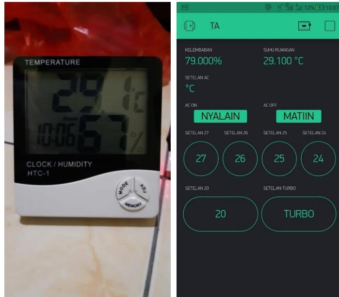
Gambar 3.10 Data Ketiga Hasil Perbandingan Sensor DHT11
