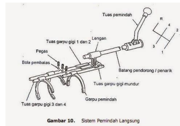
Gambar 10. Sistem Pemindah Langsung
