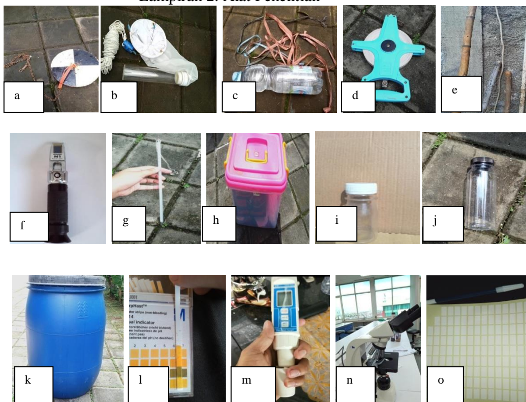
Gambar 2. Alat Penelitian (a) Secchi disk (b) plankton net (c) Alat ukur arus (d) rollmeter (e) tongkat penduga (f) refraktometer (g) thermometer (h) kontainer (i) botol sampel (j) botol sampel 30 mL (k) ember 50 L (l) pH meter (m) DO Meter (n) mikroskop binokuler (o) label dan alat tulis.
