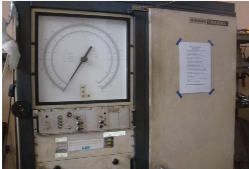
Gambar 3.8 Mesin Uji Tarik *Schenk Trebel*
