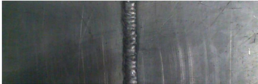
Gambar 3.6 Spesimen yang Sudah dilakukan Proses Pengelasan
