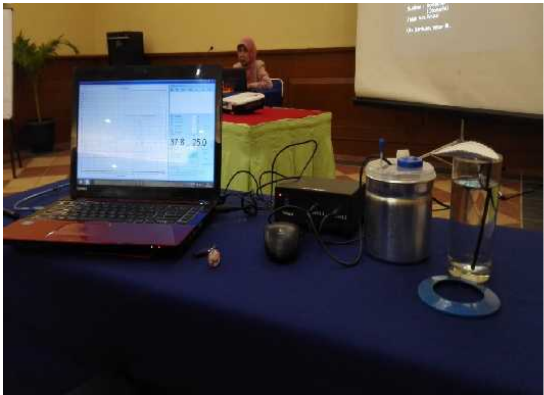
Gambar 2.6 Contoh pengembangan alat peraga kalorimeter dengan sensor suhu (Sumber: Wardhana Surabaya)
