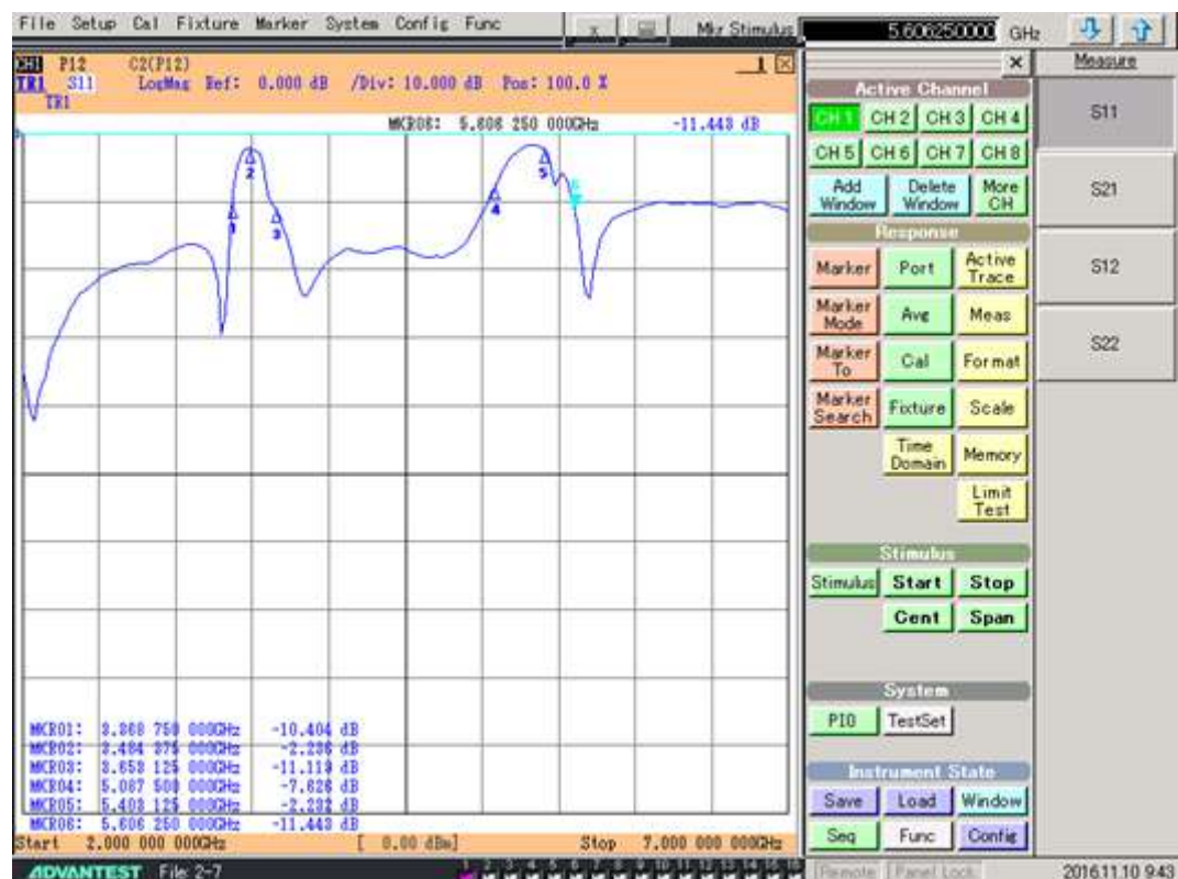
Gambar 4.24. Hasil Pengukuran ( S_{11} ) Return Loss pada Filter tanpa casing
