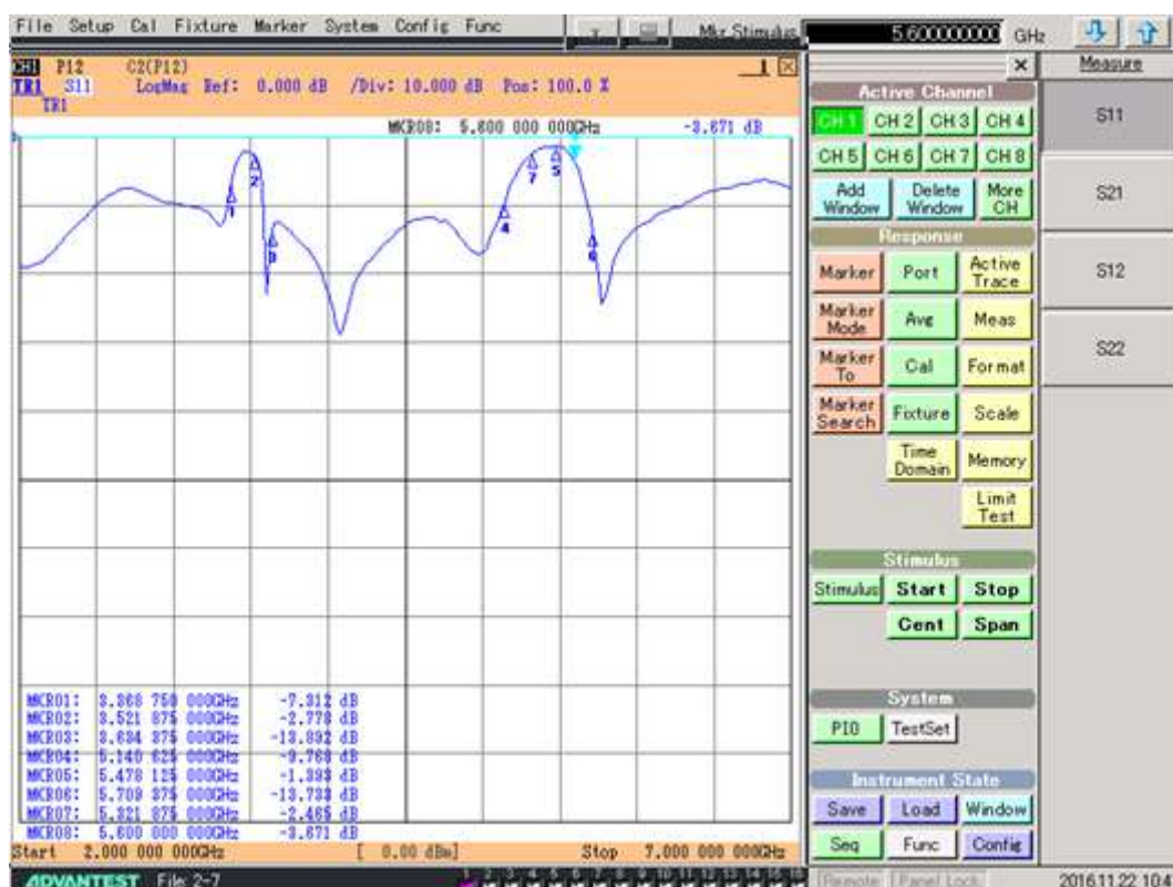
Gambar 4.25. Hasil Pengukuran ( S_{11} ) Return Loss pada Filter dengan menggunakan casing
