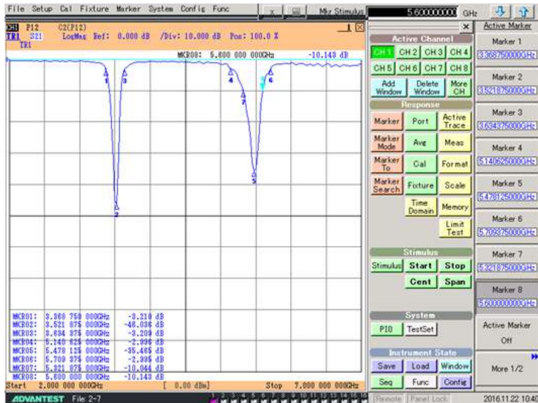
Gambar 4.23. Hasil Pengukuran ( S_{21} ) Insertion Loss dan Bandwidth pada Filter dengan menggunakan casing
