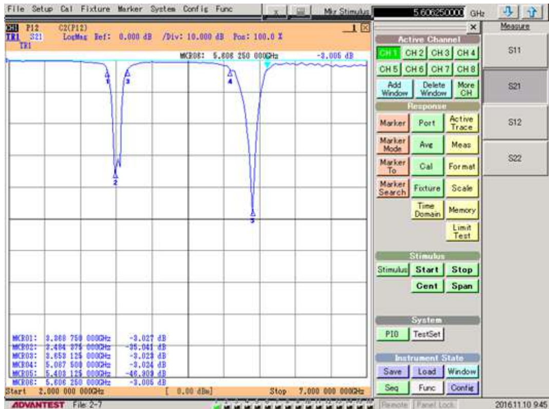
Gambar 4.22. Hasil Pengukuran ( S_{21} ) Insertion Loss dan Bandwidth pada Filter tanpa casing
