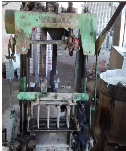
**Gambar 2.3 Mesin *Press* Hidrolik**
