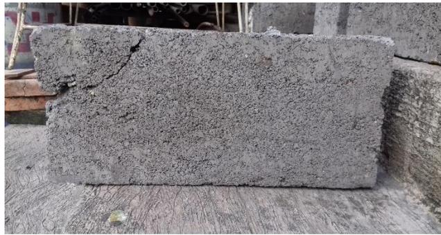
**Gambar 4.1 Cacat dan Retak Permukaan Batako**
