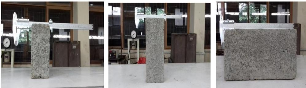
**Gambar 4.4 Pengukuran Tebal (Kiri), Pengukuran Lebar (Tengah),
