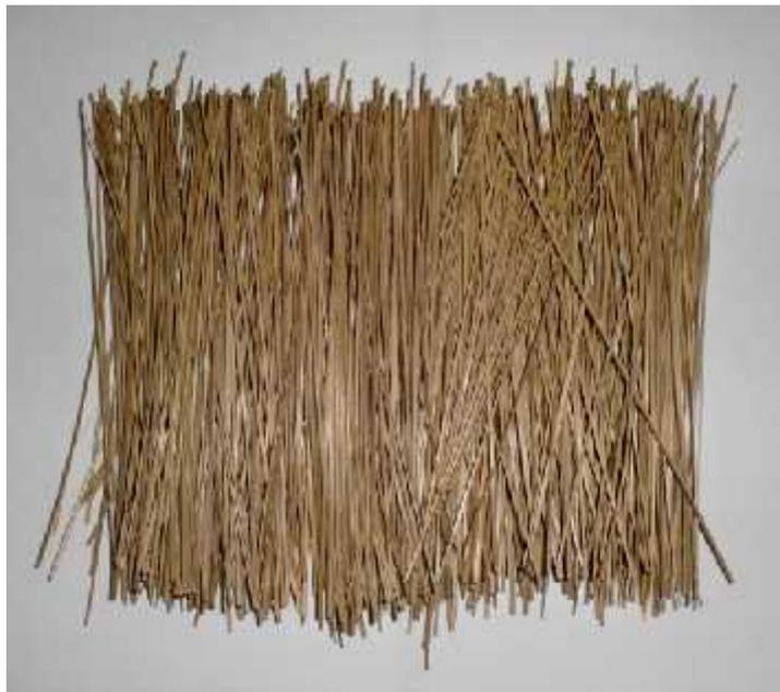
**Gambar 3.3** Serat Panjang Bambu Ampel
