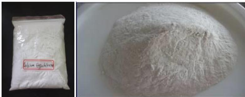
Gambar 4.6. Kalsium Hipoklorit atau kaporit
