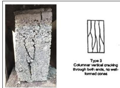
Gambar 4.5 Pola keretakan bata beton berlubang dengan pensubstitusian semen merah sebesar 0%
