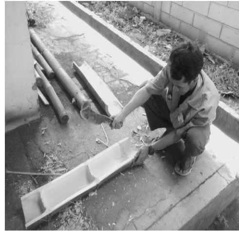
Gambar 3.14 Pembersihan buku bambu
