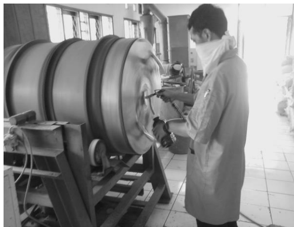
Gambar 3.21 Pemberian Perekat di dalam Glue Mixing drum
