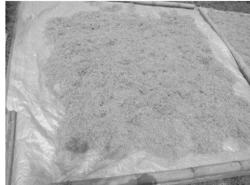
Gambar 3.20 Penjemuran partikel setelah disaring.
