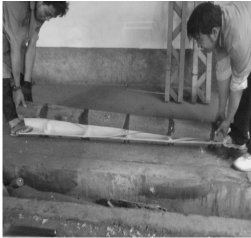
Gambar 3.13 Pembelahan bambu manual
