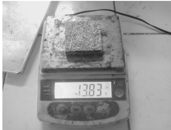
Gambar 3.8 Timbangan dengan ketelitian 0,01 g
