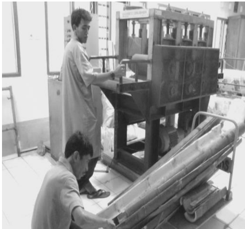
Gambar 3.15 Proses pembuatan palupuh dengan mesin bamboo crusher
