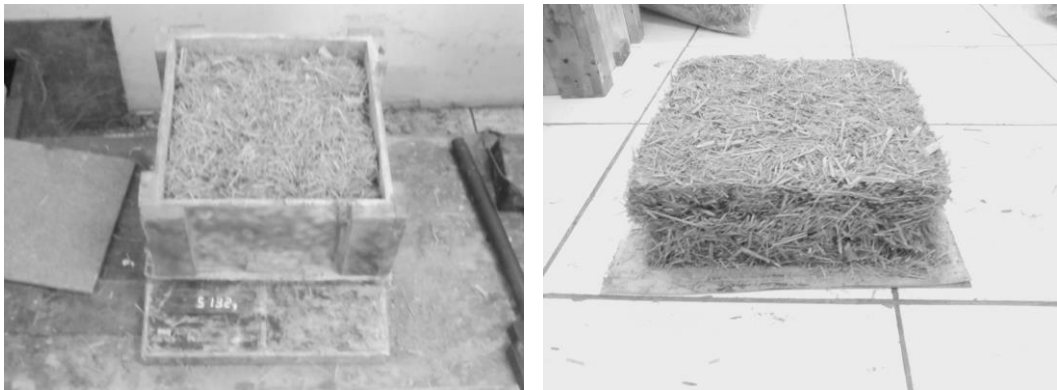
. Gambar 3.22 Proses pencetakan awal
