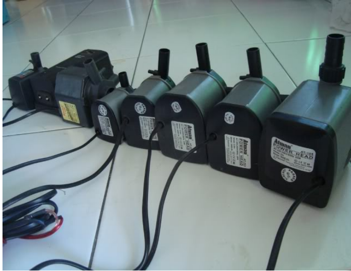
Gambar 2.2. Pompa Air Aquarium
