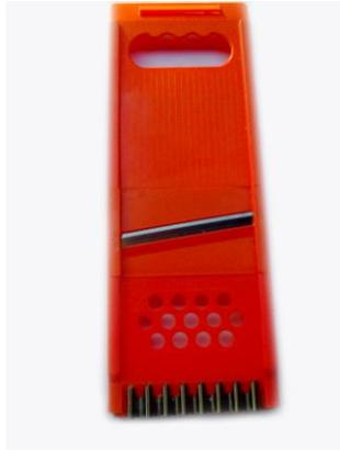
Slicer digunakan untuk menipiskan ukuran bengkuang pada pembuatan tepung bengkuang.
