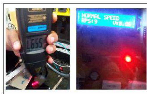
Gambar 4.12 Pembuktian Kesesuaian Alat Ukur Kecepatan Gerak Magnet Pada Set 2 Faraday (Kanan) Menggunakan RPM meter (Kiri)
