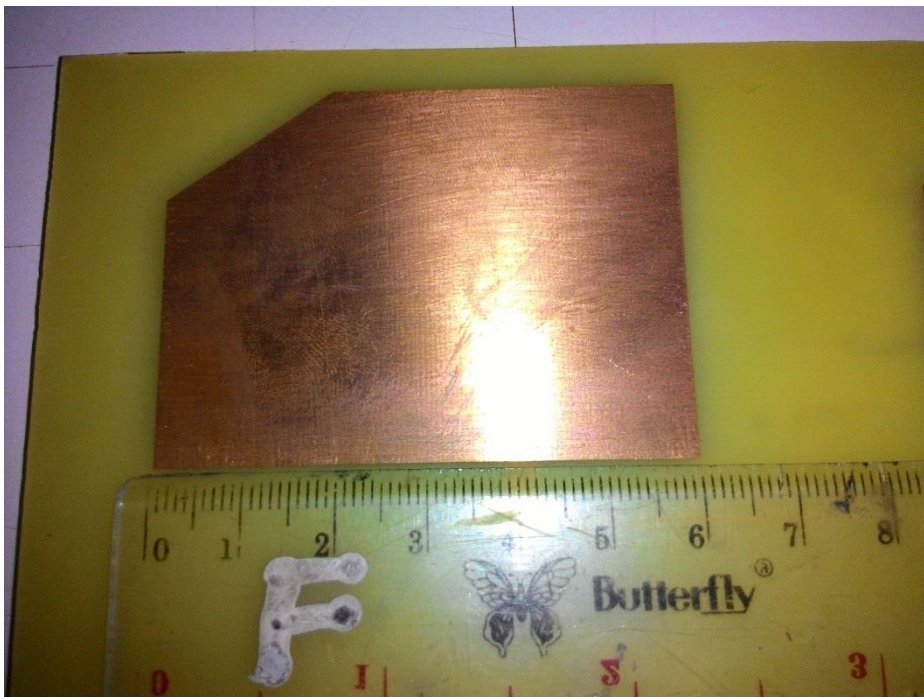
(Hasil Dimensi Panjang Dan Lebar Elemen Peradiasi Antena Mikrostrip)
