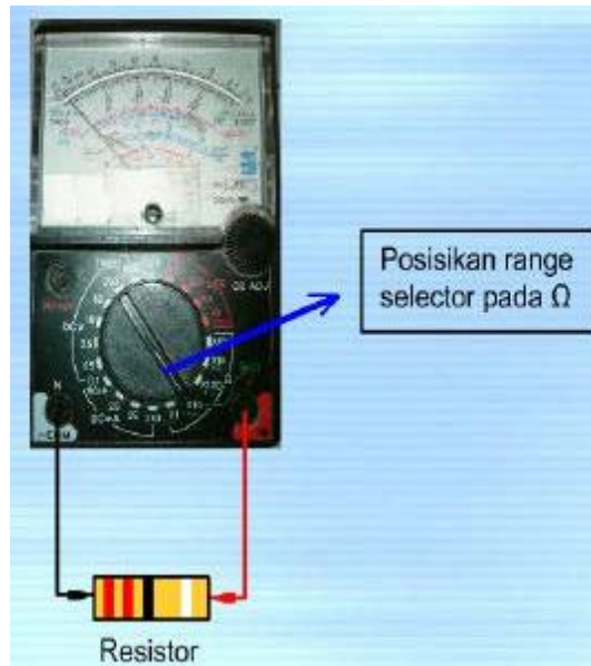
Gambar 3.27 Pengukuran Tahanan Pada Resistor
