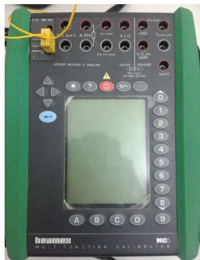
**Gambar 3.2.** Termokopel Terpasang pada MC5
