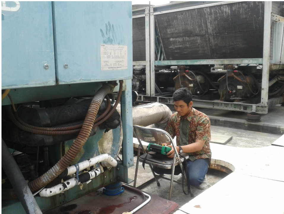
Peneliti sedang melakukan kalibrasi menggunakan MC5 ( Multifunction Calibration )
