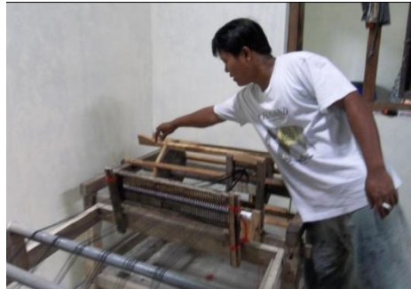
Gambar4.16 Proses Pengketengan dengan Mesin Keteng Gulung (Dokumentasi : Aghnia Nur Azizah, 27 Juni 2015)
