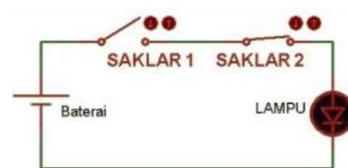
Gambar 1.7. Rangkaian saklar gerbang AND
