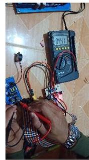
**Pengukuran Tegangan pada Rangkaian 12 V DC to 400 V DC Konverter
