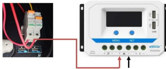
3. Kemudian kabel dua panel surya secara parallel dan hubungkan kabel (+) dan (-) dari panel surya pada *solar charger controller* seperti gambar berikut ini.
